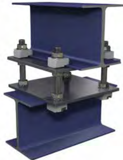
Versetzte Trägerverbindung mittels Montageplatten und Gewindestangen zur Schaffung eines Freiraumes
