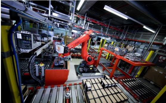
Bild 2: Behälter-Kommissionierroboter.jpg
